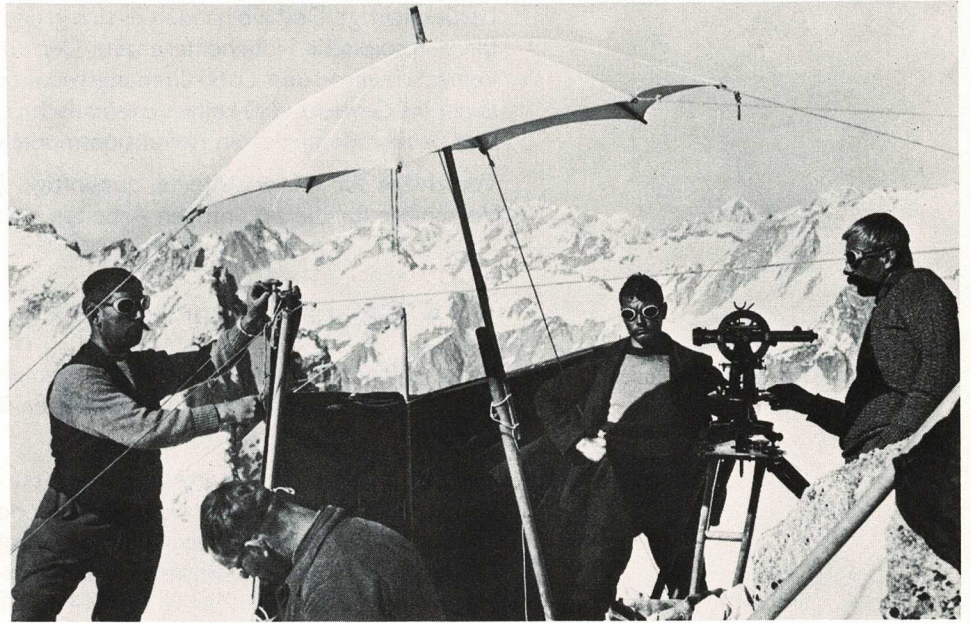
Bild 2.16 Winkelmessung auf der Cima della Bondasca im Netz
