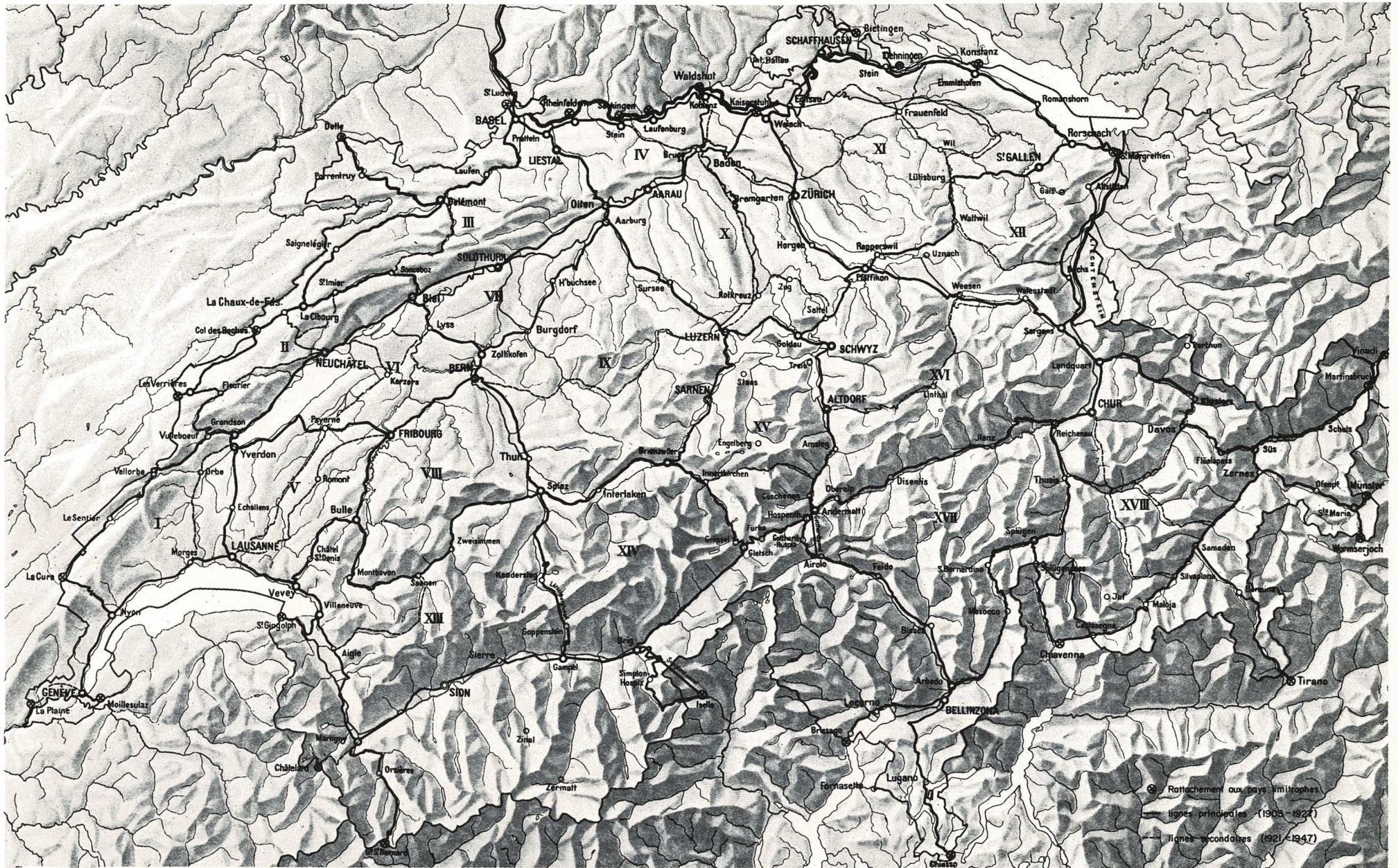
Bild 2.15 Das Präzisionsnivellement der Schweiz
