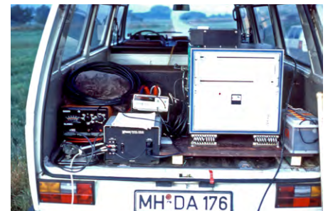
Fig. 1: Premier récepteur GPS géodésique Macrometer V-1000 avec alimentation électrique dans le bus Volkswagen. Utilisation dans le réseau test (3D) de Tourtemagne en 1985 (photo swisstopo).
