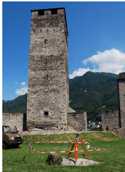
Abb. 2: GNSS-Landesnetz LV95. Stationierung auf Verdichtungspunkt «Bellinzona» (Castelgrande) in der Messkampagne CHTRF2010 (Foto swisstopo).
