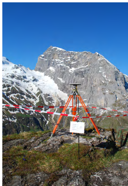
Fig. 2: Réseau GNSS national MN95. Récepteur en station sur le point principal «Engelberg» (Titlis), campagne de mesure CHTRF2010 (photo swisstopo).
