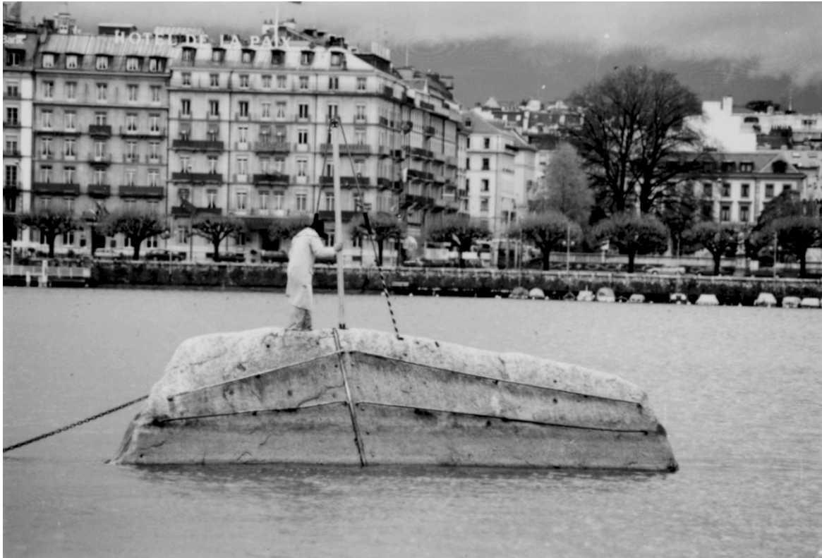
Abbildung 4.3-6: Höhenbezugspunkt des Landesnivellements ( LN02 ): Repère Pierre du Niton (RPN)
