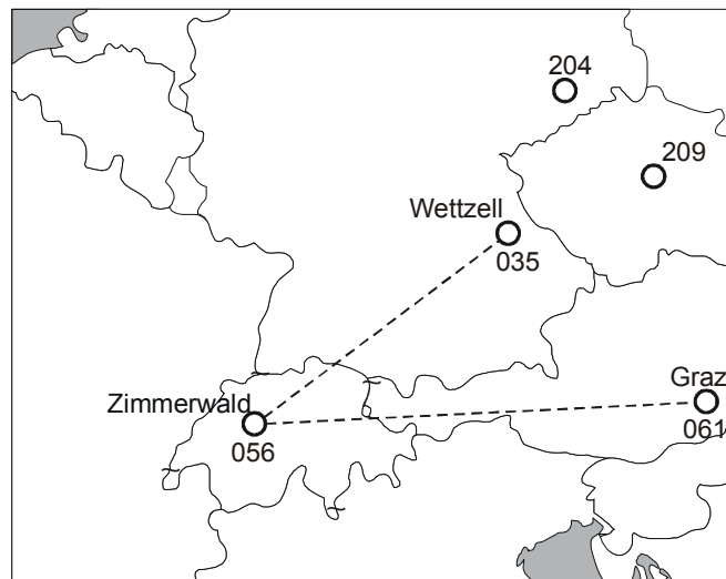
Abbildung 4.2-1: Verbindung des GPS-Netzes LV95 mit den 'ITRS fiducial stations' und mit dem europäischen Netz EUREF
