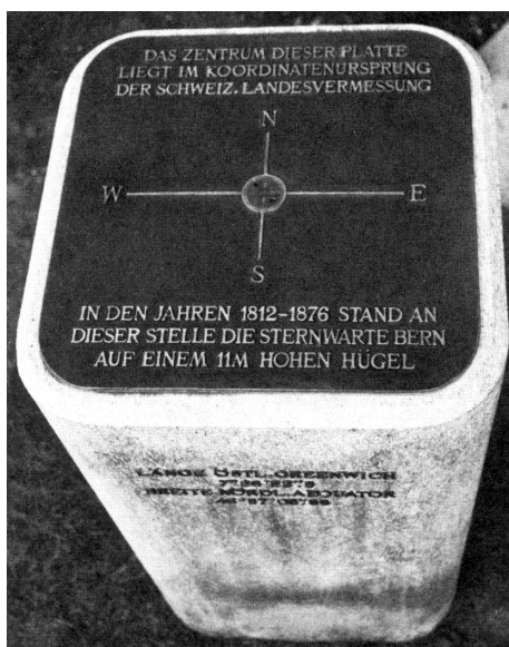
Abbildung 4.3-3: "Gedenkstein" für den alten Fundamentalpunkt (CH1903)
