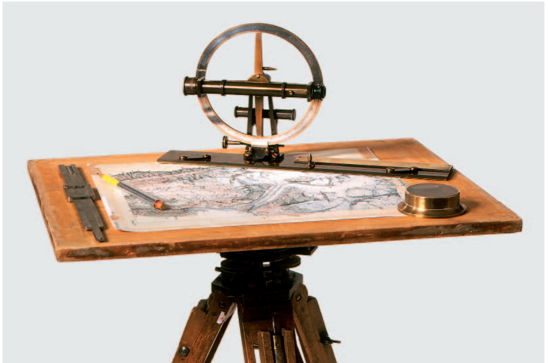
Arbeitsinstrument: Kippregel und Stativ mit umlegbaren Beinen.
